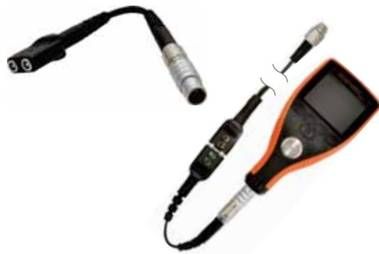
Om 'niet-intelligente' transducers met dubbelvoudige elementen aan te kunnen sluiten, sluit u de adapter simpelweg aan op het aansluitpunt van de transducer in het huis van de meter en volgt u de instructies op het scherm.
