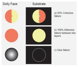
Cohesive Failure Layer<sup>d</sup>
